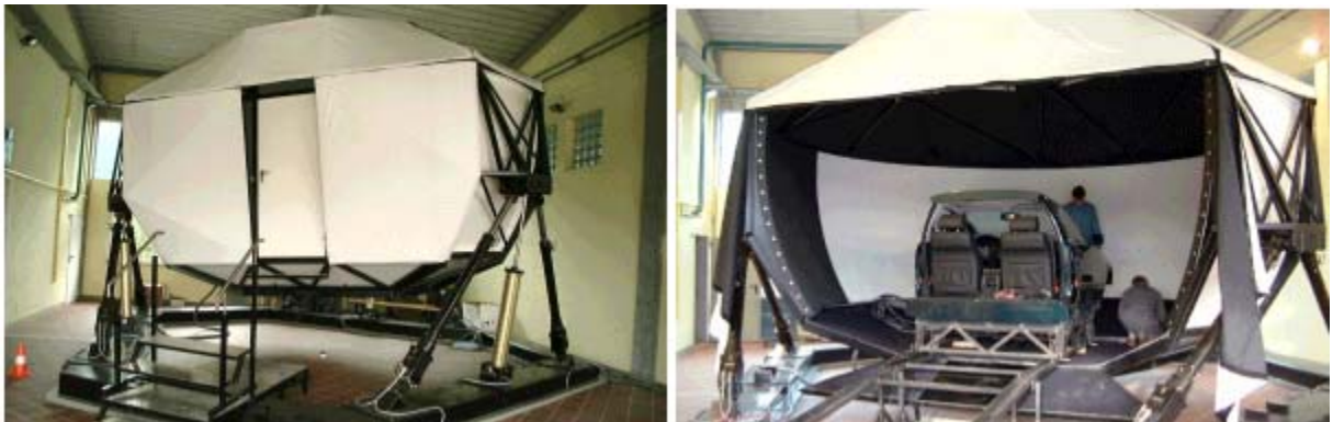
Abbildung 4-1: Der Würzburger Fahrsimulator in Betrieb (links) und während des Aufbaus (rechts). In der Kuppel zu sehen sind die Fahrzeugkonsole (BMW 520i) und die Projektionsfläche für die Frontsicht. / The Würzburg driving simulator while operating (on the left) and under construction (on the right). In the cupola you can see the car console (BMW 520i) and the projection screen that displays the front sight.
