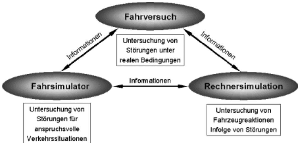
Abbildung 8: Vernetzung unterschiedlicher Entwicklungswerkzeuge / combination of different development tools
